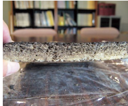
試験終了後のF Bパネルの断面
